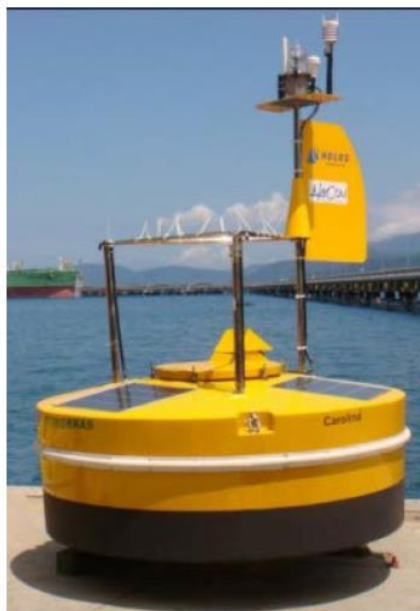
Figura 2 - Modelo de boia oceânica para monitoramento. Fonte: Anexo 8, TR4.
